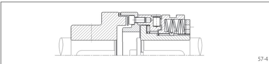
Pour une liaison flexible entre deux arbres. Possibilité de compenser des désalignements angulaires et radiaux importants.
