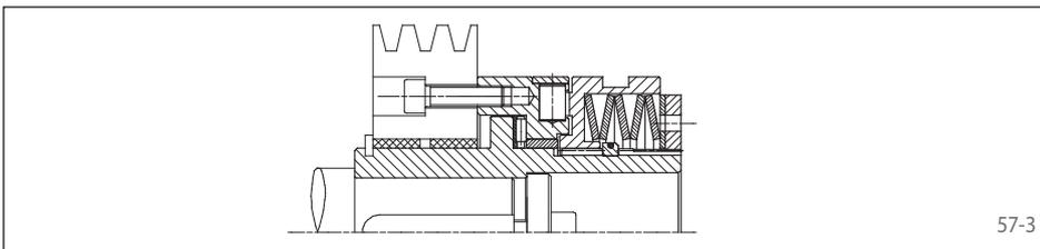
Avec moyeu long pour organe de transmission de grande largeur. Le palier ou roulement support de ce composant est fourni par le client.
