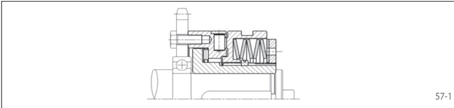
Pour le montage de roues à chaîne, de poulies, de pignons, etc. Le centrage de l'organe de transmission sur l'arbre est à la charge du client.
