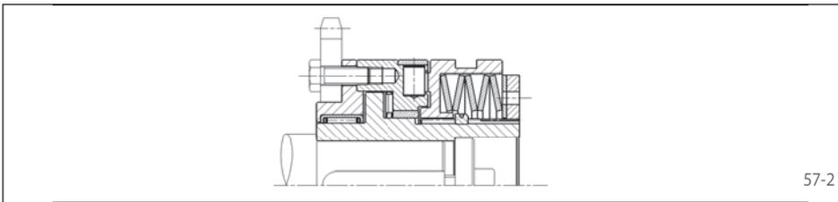
Avec moyeu court et roulement à aiguilles intégré pour montage d'organes de transmission étroits.
