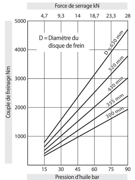
Les couples donnés dans ce tableau sont calculés avec un coefficient de friction théorique de 0,3.
