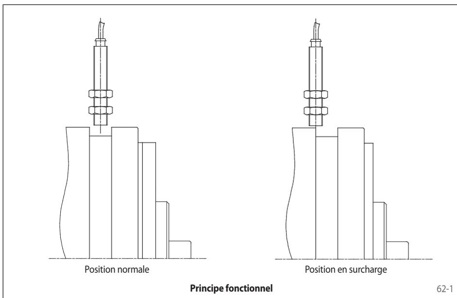
Avec un limiteur de couple SIKUMAT®, il est possible d'utiliser le mouvement axial généré par la surcharge pour actionner un détecteur de proximité de façon à couper l'alimentation électrique du moteur et/ou générer un signal.
