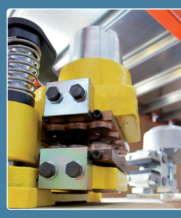
Für die Dimensionierung einer industriellen Scheibenbremse sind in Abhängigkeit ihres Einsatzgebietes das Wirkprinzip und die konstruktive Ausführung von Bedeutung. Dabei gilt es, den Wärmehaushalt sowie den Verschleiß ebenfalls mit einzukalkulieren. Zudem gibt es weitere Faktoren, die bei der Auslegung ebenfalls eine Rolle spielen.
