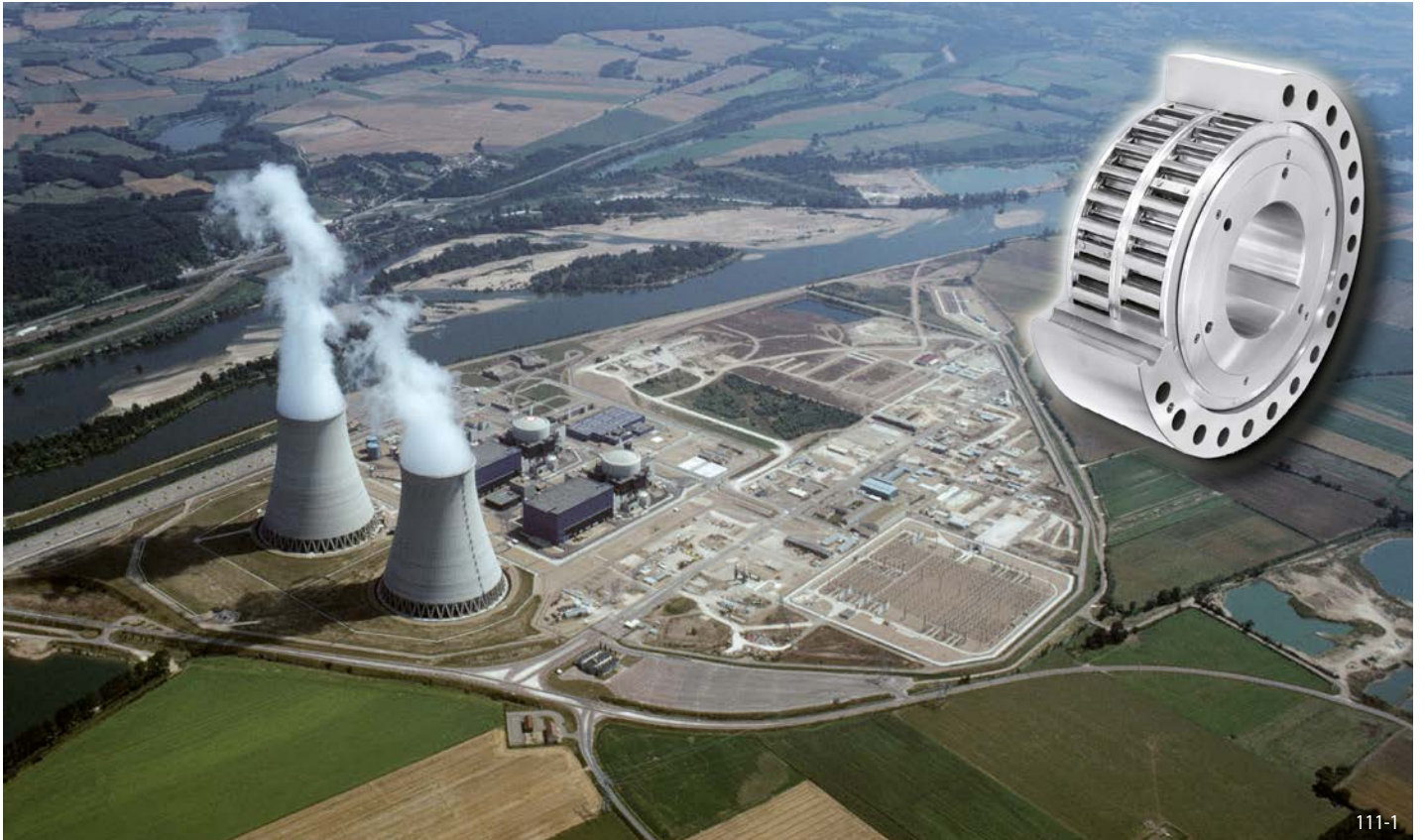
Rücklaufsperre FXM 2.410 - 100 LX für die primäre Kühlwasserpumpe in einem Kernkraftwerk. Maximales Drehmoment 500 000 Nm, Drehzahl 1 485 in -1 . Seit 1996 im Einsatz. Gefertigt und getestet mit einer umfassenden Dokumentation von RINGSPANN GmbH, Bad Homburg.
