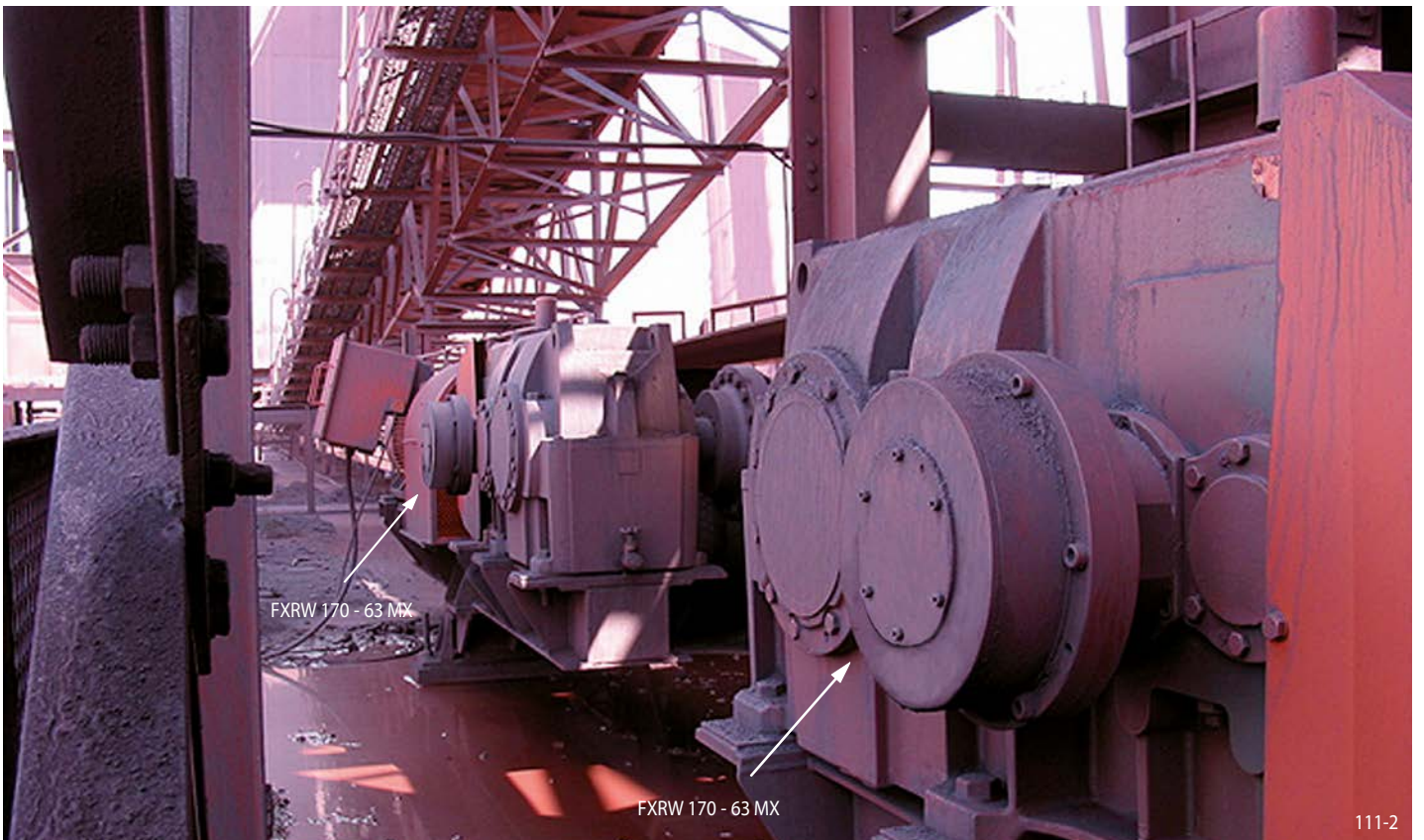
Bandanlage zur Förderung von Eisenerz in Südafrika; angetrieben von drei Getrieben mit RINGSPANN Rücklaufsperren FXRW 170 - 63 MX.
