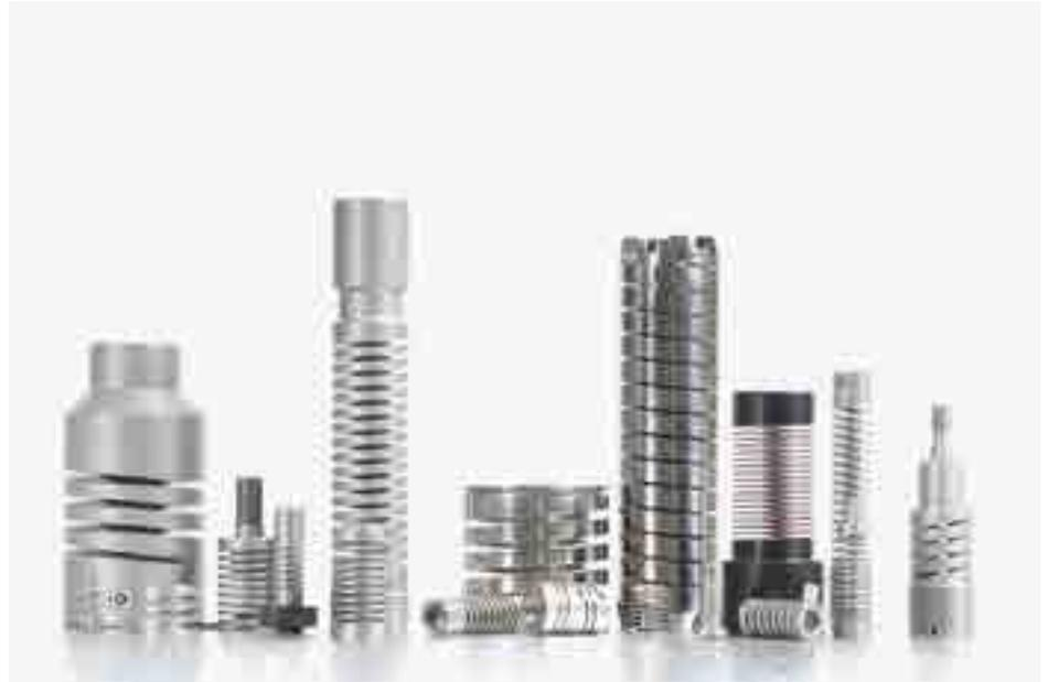
Ce procédé de façonnage est mieux approprié que l'enroulement d'un ressort car, contrairement au formage sans enlèvement de copeaux, il ne génère pas de contraintes additionnelles mais uniquement la tension naturelle du matériau. De ce fait, le ressort obtenu présente une caractéristique de flexibilité d'une bonne reproductibilité et d'une bonne résistance à la fatigue.
