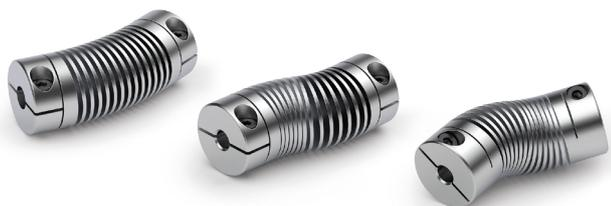
Axiale Winkelversätze oder -verlagerungen sind in den Antriebssystemen des Maschinen- und Anlagenbaus keineswegs selten. Die Wendelkupplung kann sie über die Minimierung ihrer inneren Stege und die Maximierung ihrer äußeren Stege ausgleichen. Sofern ausreichend Abstand zwischen den Umläufen der wendelförmigen Nut vorhanden ist, können auf diese Weise axiale Verlagerungen von bis zu 20° oder mehr kompensiert werden. Noch höhere
